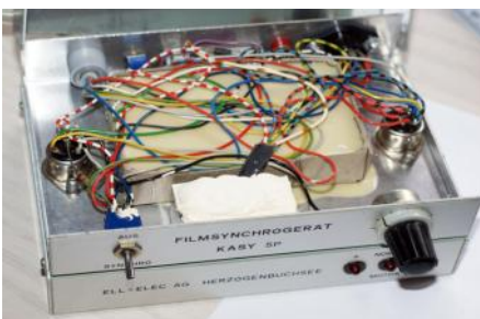
Steuergerät für die Synchronisation.
